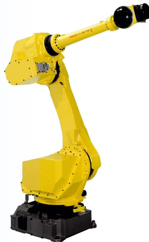
M-710 i C/50 可达半径 2050 mm 最大负载 50 kg
